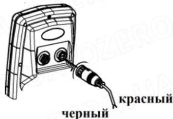
**2.** Подключите ЧЕРНЫЙ провод к минусу (-) клеммы батареи или соответствующего заземления.
