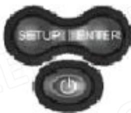
ПРИМЕЧАНИЕ: прибор необходимо отключить для входа в обычный рабочий режим из симуляционного режима. Функция автоматического отключения питания: дисплей автоматически отключается, когда глубина не определена и показания глубины отображаются как «--» в течение 5 минут непрерывно.
