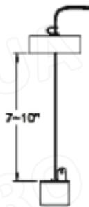
**6.3.** Эхолот укомплектован адаптером, монтажной скобой для датчика эхолота (рис. 16). Адаптер имеет монтажные зажимы, так что вы можете прикрепить его к любой плоской поверхности или корпусу лодки (рис. 17), и соответствующую штангу. Адаптер является съемным и регулируется до 180 градусов.
