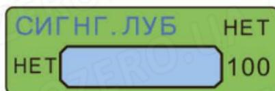
Нажмут кнопку функционального меню, пока показывают пункт меню по сигнализации глубины. Выбор состояния о выключении будет выключать функцию по тревоге глубины, или из серийной цифровой сферы глубины выбирают сигнализацию соответственных глубин, когда реальная глубина ниже настроенной цифры, функция по сигнализации глубины будет напоминать внимание. (выключение, 1-100 метров).
