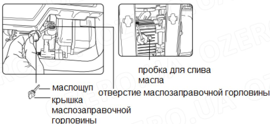
2. Добавьте масло (тип масла: 15W/40 SE) 500 мл (Рис.2), закройте крышку маслозаправочной горловины и очистите её тряпкой, затем верните генератор в горизонтальное положение.
