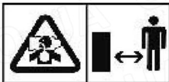
В процессе эксплуатации выхлоп из этого генератора содержит ядовитый углеродный монооксидный газ. **ИСПОЛЬЗУЙТЕ ЭТОТ ГЕНЕРАТОР ТОЛЬКО НА НЕОГРАНИЧЕННОМ ПРОСТРАНСТВЕ.** Этот генератор должен эксплуатироваться только в хорошо проветриваемом помещении на расстоянии от других объектов в несколько футов с каждой стороны.
