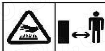
Этот генератор сильно нагревается во время работы. Генератор остается горячим в течение нескольких минут после выключения. Не прикасайтесь к горячим поверхностям, особенно к выхлопным компонентам системы. Изучите и придерживайтесь всех предупреждающих знаков с надписью «HOT». Генератор не следует переносить в закрытое помещение для хранения до тех пор, пока он не остыл полностью.
