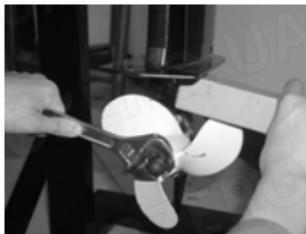
1. Проверьте каждое из лезвий винта на предмет износа, коррозии от кавитации или вращения, и наличие других повреждений.
