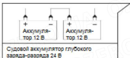
Используйте судовой аккумулятор глубокого заряда-разряда 24 В для вашего мотора. Неправильное использование аккумулятора повредит мотор.
