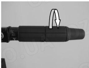
2. Быстро сдвиньте рычаг переключения передач и переведите его из нейтрального положения в положение хода вперед. Потяните вверх переключатель нейтральной передачи и переведите рычаг дистанционного управления быстро одним движением из нейтрального положения в положение хода вперед (дистанционное управление).
