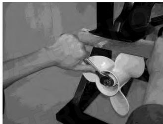
1. Проверьте каждое из лезвий винта на предмет износа, коррозии от кавитации или вентиляции или наличие других повреждений.
