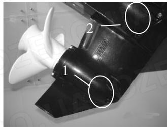
1. Винт сливного отверстия
