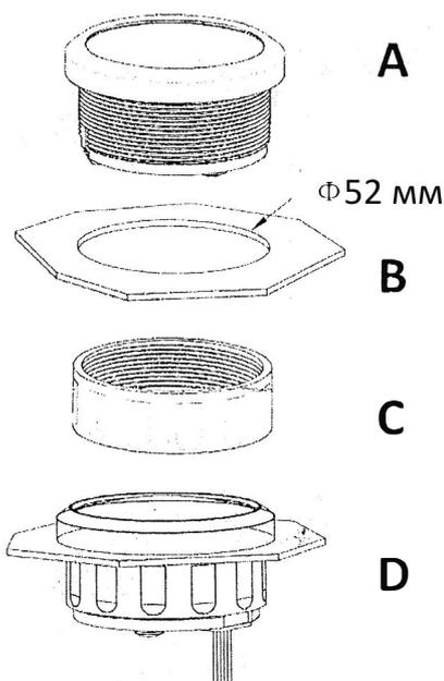
Рис. В: Перед установкой сделайте отверстие диаметром 52 мм. Также удостоверьтесь в том, что у вас есть 55 мм пространства для размещения задней части прибора.
